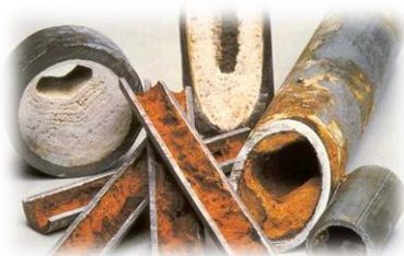
Exemple de tubes corrodés ou encrassés
